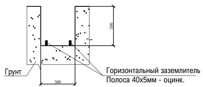
Рисунок 2. Траншея для полосы 40x5мм (оцинк.)
